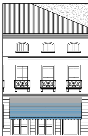
Tenda solare collocata su edifici con trattamenti particolari al piano terra
